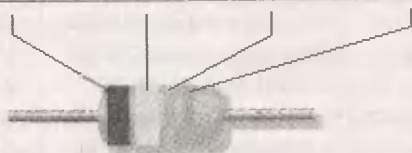
Рис. 12. Цветовая маркировка диодов по европейской системе PRO ELECTRON
